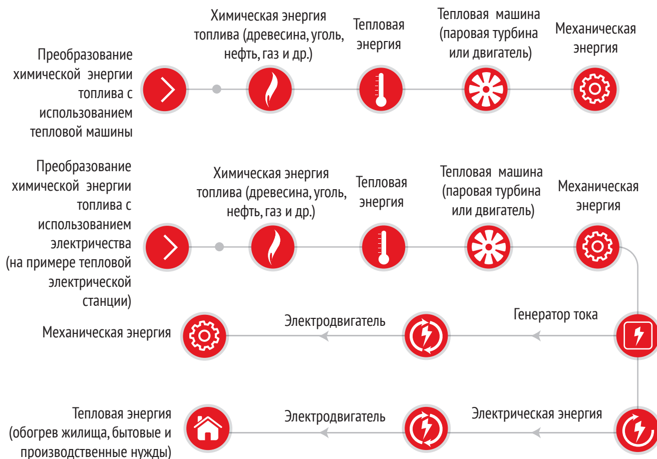
Рисунок 1.15. Преобразование энергии на тепловой электрической станции
